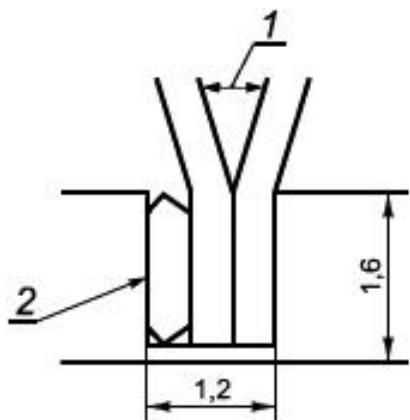
1 - отдельные термоэлектроды; 2 - расположение термопары общим наружным диаметром 0,254 мм: в отверстие вдавливается пробка до полного заполнения. Точка разделения термоэлектродов находится на поверхности медного диска
