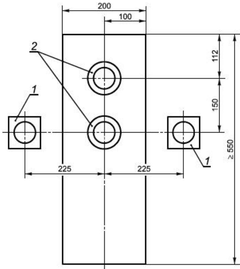
1 - контрольные датчики; 2 - датчики, вмонтированные в панель
