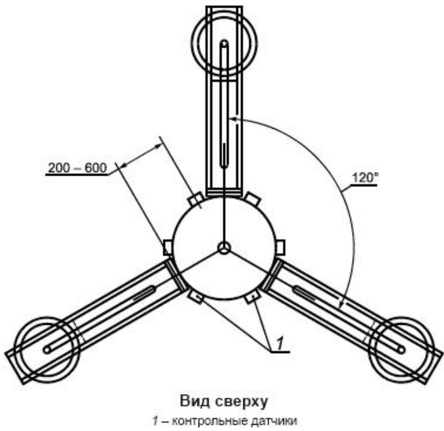
Рисунок 2 - Метод А: Схема расположения трех панелей с датчиками и двумя контрольными датчиками с каждой стороны
