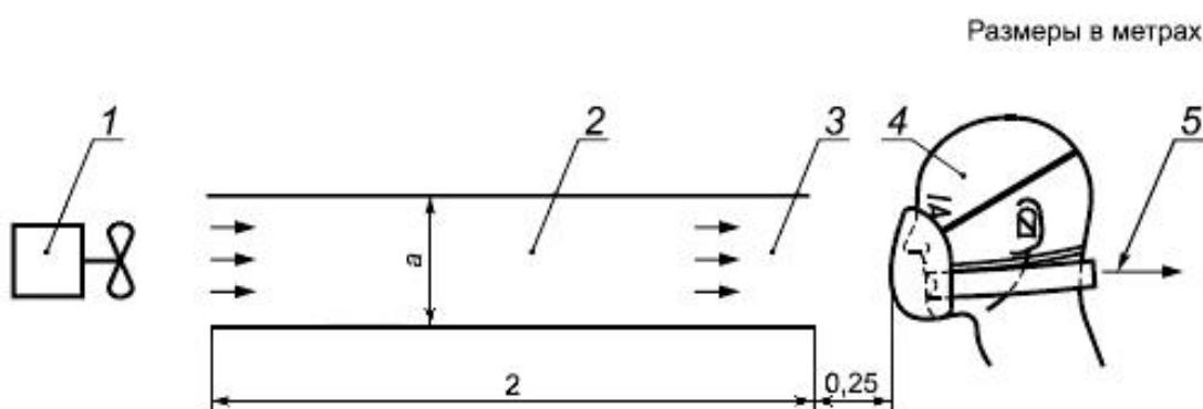
1 - вентилятор; 2 - трубопровод; 3 - датчик воздушного потока; 4 - голова манекена; 5 - по направлению к дыхательной машине; размер "а":  $(0,3 - 0,5) \text{ м}$
